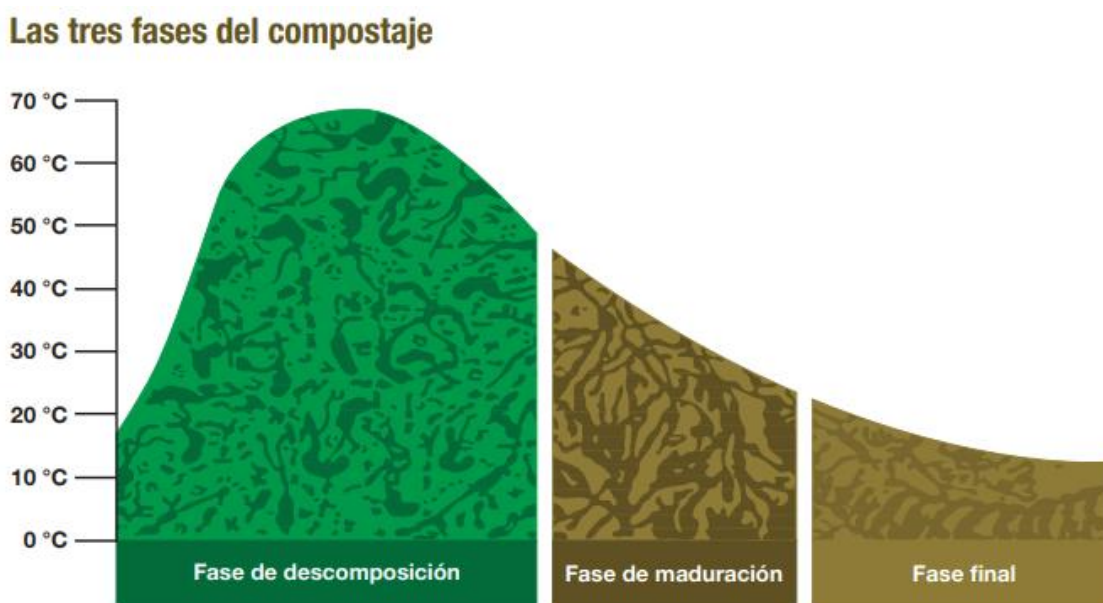
Ilustración 11: Temperaturas en las Fases del compostaje
