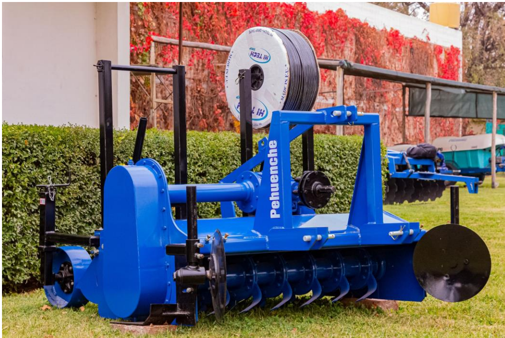
Imagen N° 5: Formadora de camas
