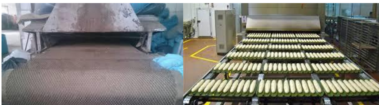
Ilustración 5 horno de túnel-producción continua
