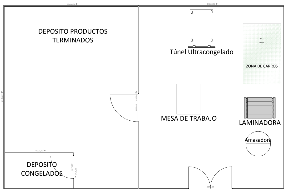
Ilustración 19 Lay-out sector productivo
